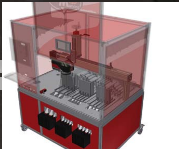
Laser Modula Evo Tag S con 11 caricatori, sfogliatori e celle di scarico asselinate per il posizionamento della testina della targhetta selezionata
