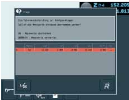
4. Prueba de tolerancia: cuando se sobrepasa la tolerancia establecida, aparece un mensaje luego de la medición, que le indica al operador la transgresión.
