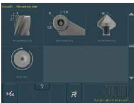
7. Programas de medición guiados por sistema con diálogo de entrada de realidad fotográfica, p. ej. el mayor filo en cabezales portacuchillas, concentricidad y planicidad, punta teórica en brocas, etc.
